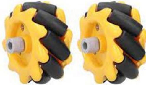
*Slika 17. Mekanum točak specifikum RoboLab laboratorije*
