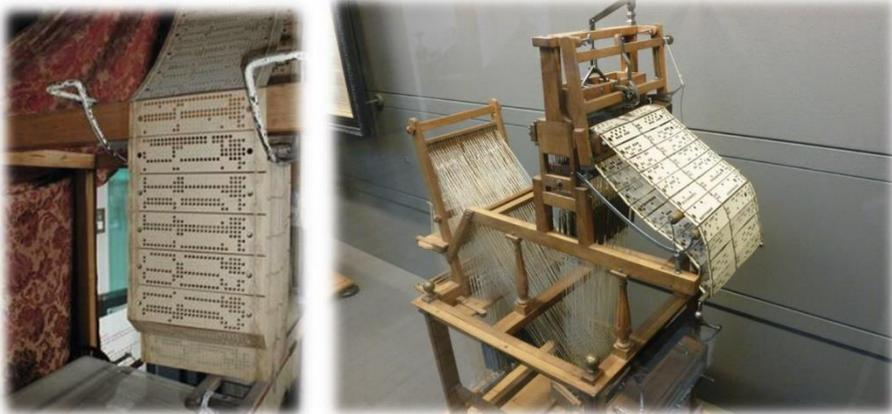
Slika 12 Jacquardove bušene kartice automatski tkaju složene uzorke u tekstu – Babbageov uzor za analitičku mašinu.
