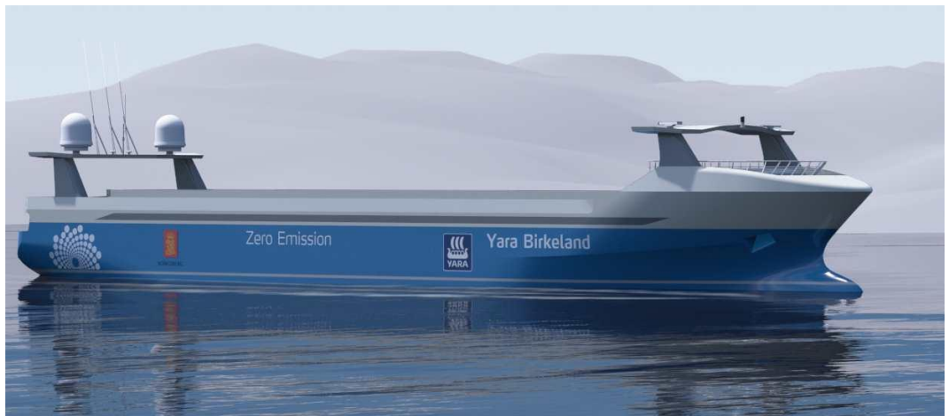
Slika 1. Električni i autonomni kontejnerski brod Yara Birkeland [19]
