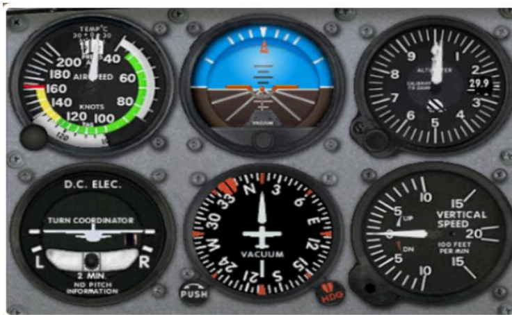
Slika 1. Osnovnih šest letačkih instrumenata-Basic six
