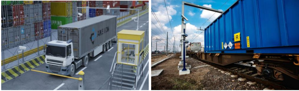
Slika 12. OCR sistem u kontejnerskim terminalima [32, 33]
