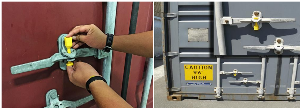
Slika 8. Plombe za zaključavanje kontejnera [25]
