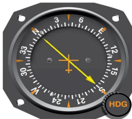
Slika 2. ADF uređaj u avionu za dobijanje signala NDB
