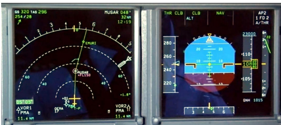
Slika 4. Sistem elektronskih instrumenata – digitalni - za letenje - EFIS
